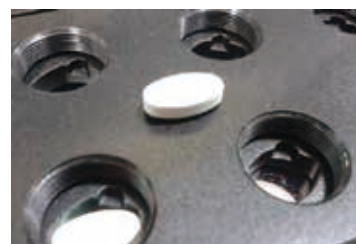
錠剤を Beam Enhancer トレイに配置
